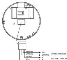
Chaque détecteur est fourni avec un connecteur avec un câble bleu, un câble noir et deux câbles bruns. Raccordez le câble bleu avec une phase 230Vac. Connectez le fil noir au neutre 230Vac. Les fils bruns sont la connexion au relais de sortie NO: normalement ouvert.
